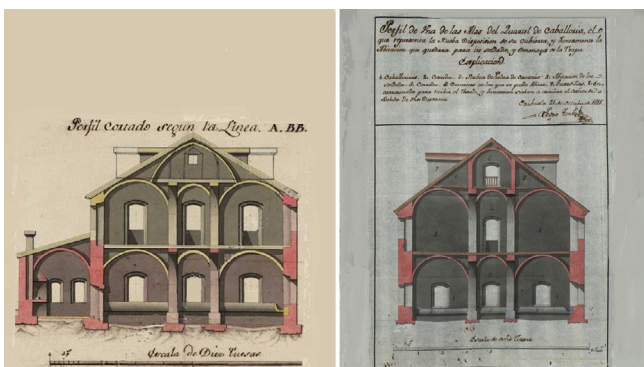
Figura 13. Cuartel Orihuela Pedro Torbe (1747). Empuje bóvedas, [MPD, 27, 062], [MPD, 67, 080].
