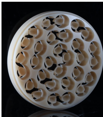
Figura 7. Discos de PMMA A2 fresado: Vista de la parte interior de las coronas
