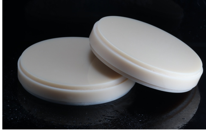
Figura 4. Discos de PMMA+Grafeno y PMMA A2
