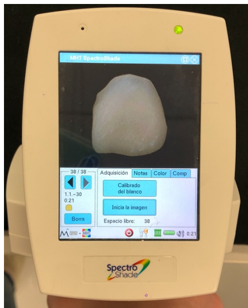
Figura 13. Toma de color con el espectrofotómetro Spectroshade™ Micro de muestra de PMMA+Grafeno
