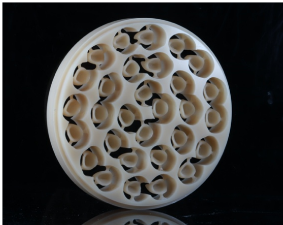
Figura 5. Discos de PMMA+Grafeno A2 fresado: Vista de la parte interior de las coronas
